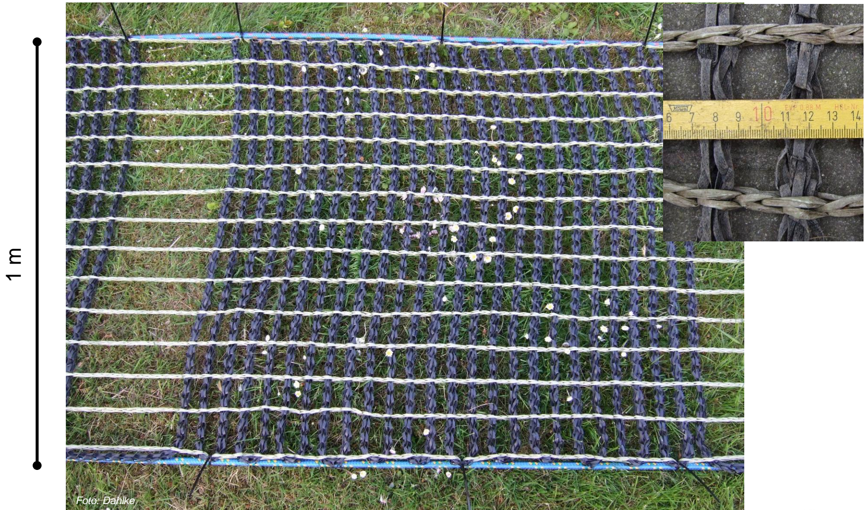
Aufwuchsträger aus PP-Gurtband, Hersteller: Sächsisches Textilforschungsinstitut e.V. (STFI), Chemnitz
